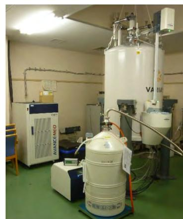
図 1. AVANCE NEO 700 の装置の外観
